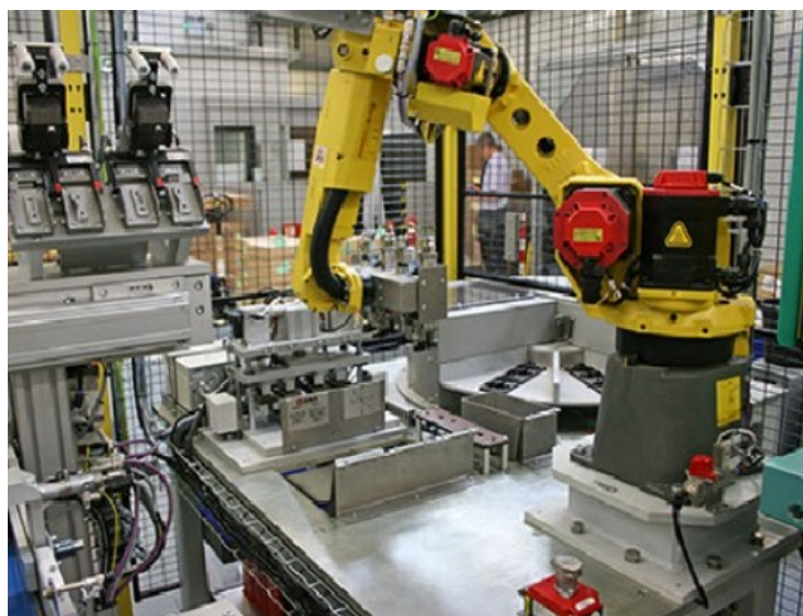
Obr. 25 Robotický manipulátor zakládající insert do vstřikovacího stroje [42,43]
