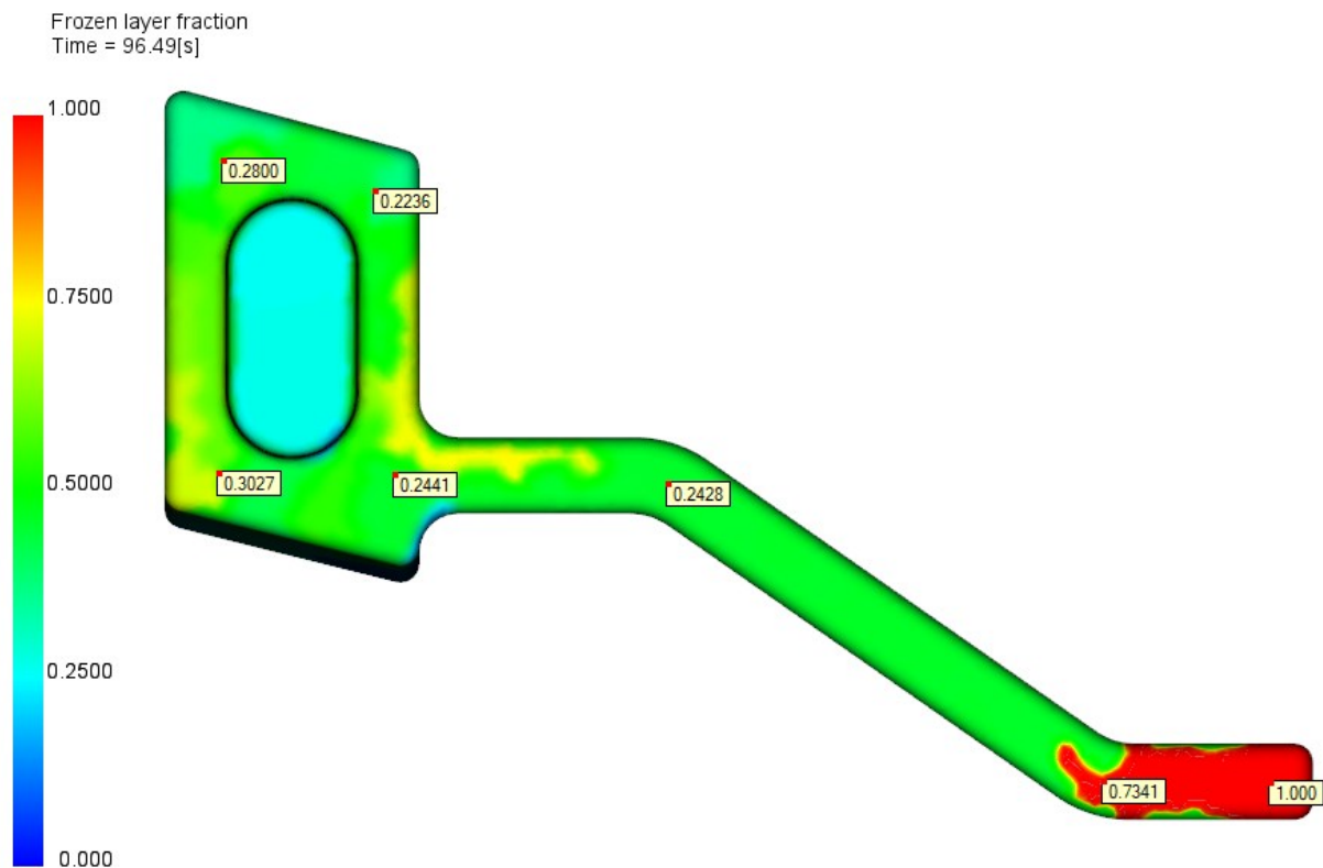
Obr. 80 Zobrazení procenta zatuhlé vrstvy na zástříku v čase 96,49 s
