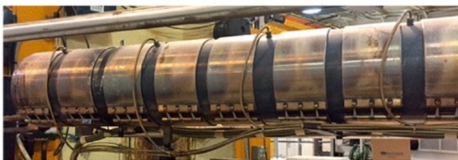
Obr. 11 Topná tělesa na povrchu válce s termočlánky [12]
