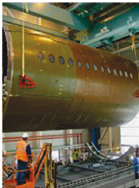
Obrázek 21 Laminátový Trup letadla vyrobený navíjením [18]
