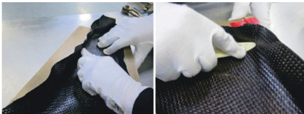
Obrázek 19 Ruční formování prepregu [18]
