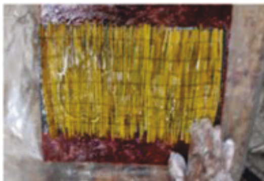
Obrázek 12 Vlákna z rýžové slámy zalitá v pryskyřici [14]
