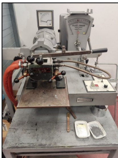
Obrázek 24 Laboratorní gumárenský hnětič Brabender
