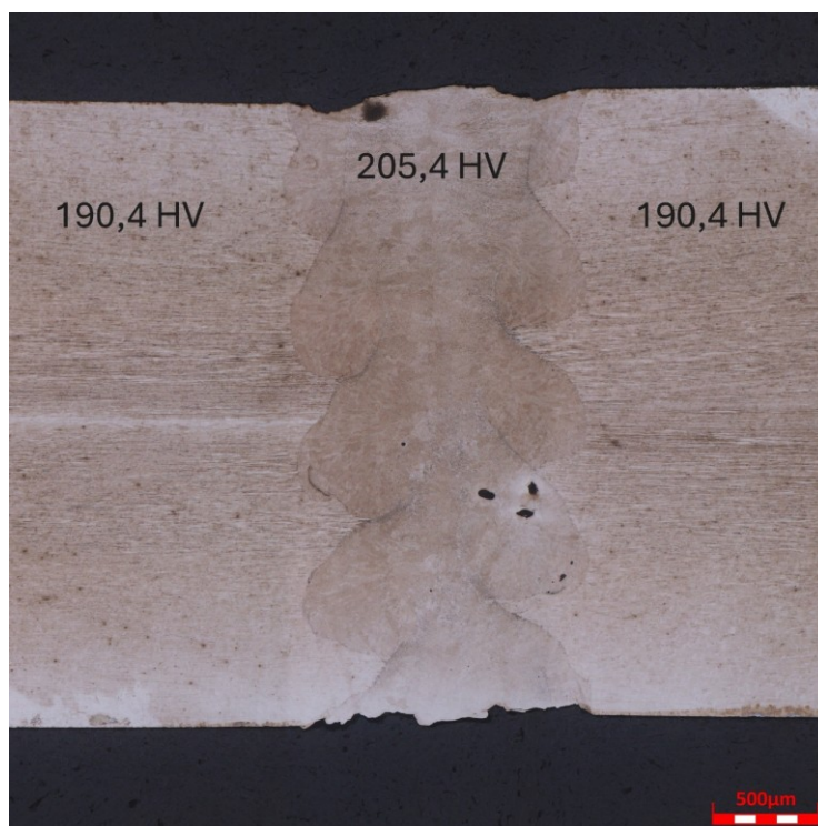
Obrázek 43 Kompoziční snímek svaru s hodnotami vtiskové tvrdosti pro vzorky HB
