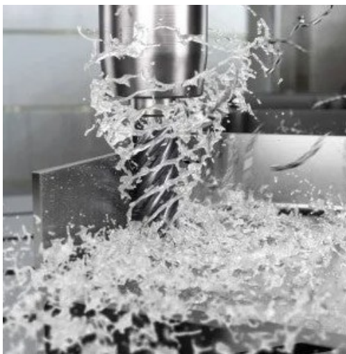
Obrázek 31 – Obrábění za vysokých řezných rychlostí s použitím chladících médií
