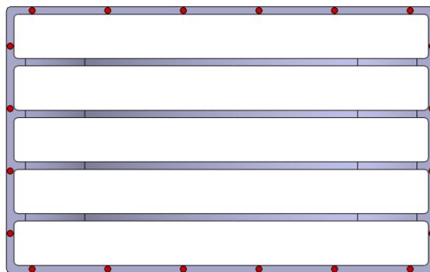
Obrázek 49 Místa působení vyhazovacích kolíků na výstřiku
