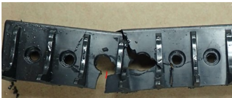
Obrázek 18 Mechanické selhání v oblasti studeného spoje [12]
