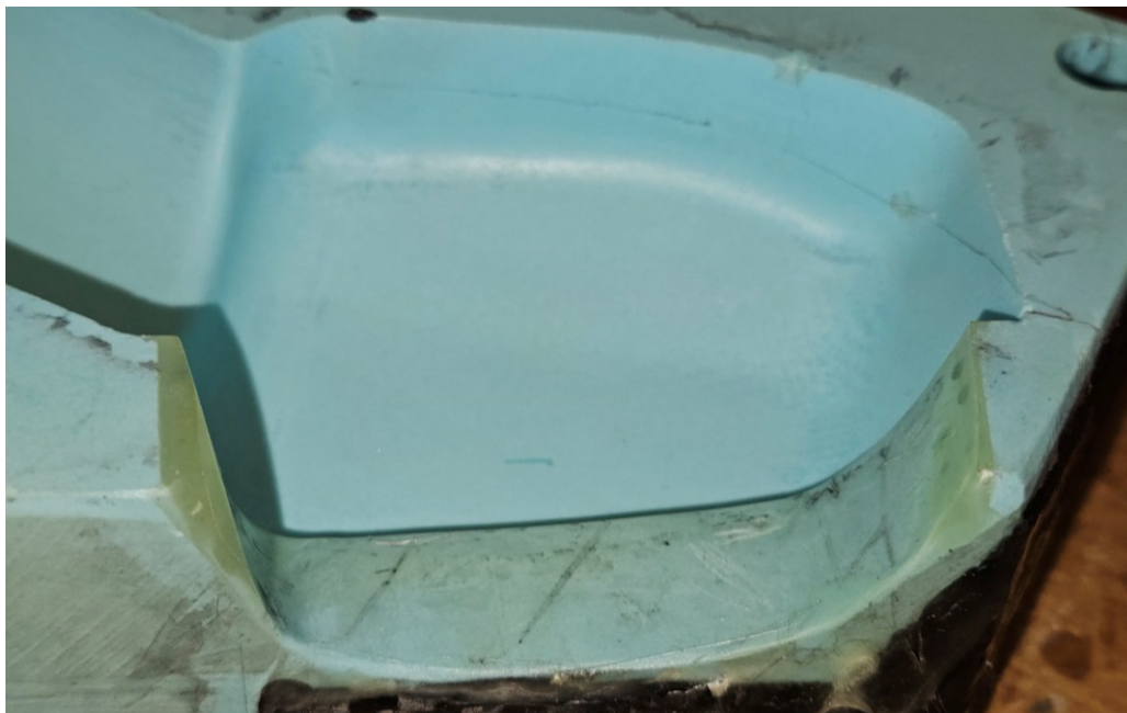
Obrázek 22 Opravený defekt na epoxidové formě
