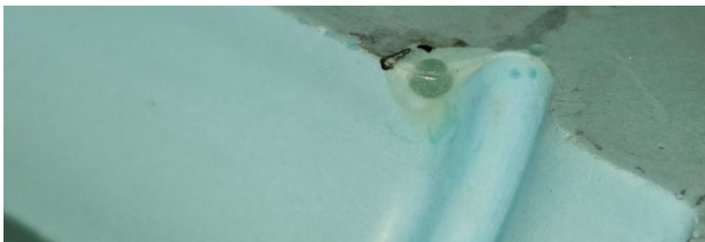
Obrázek 23 Opravený defekt na hraně epoxidové formy
