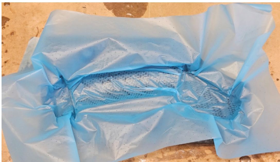
Obrázek 40 Odtrhová fólie před debulkingem
