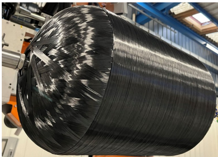
Obrázek 11 Tlaková nádoba vyrobená technologií navíjení vláken [24]
