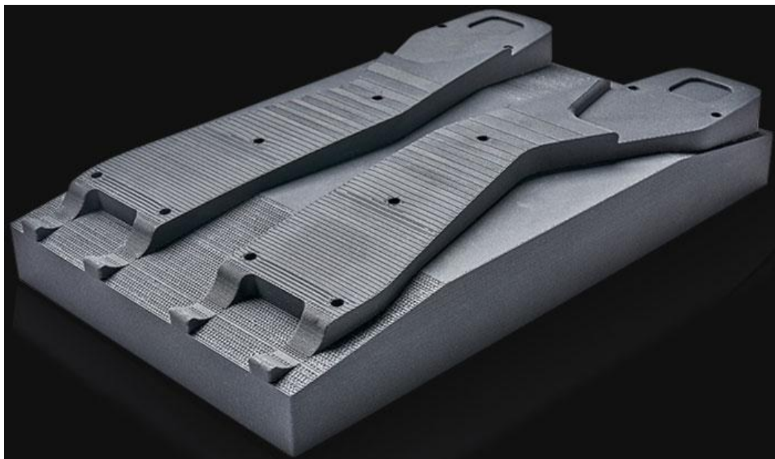
Obrázek 16 Forma vyrobená technologií 3D tisku [35]
