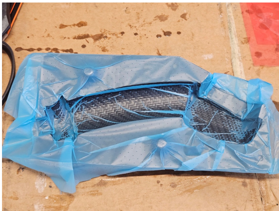
Obrázek 43 Odtrhová fólie po debulkingu
