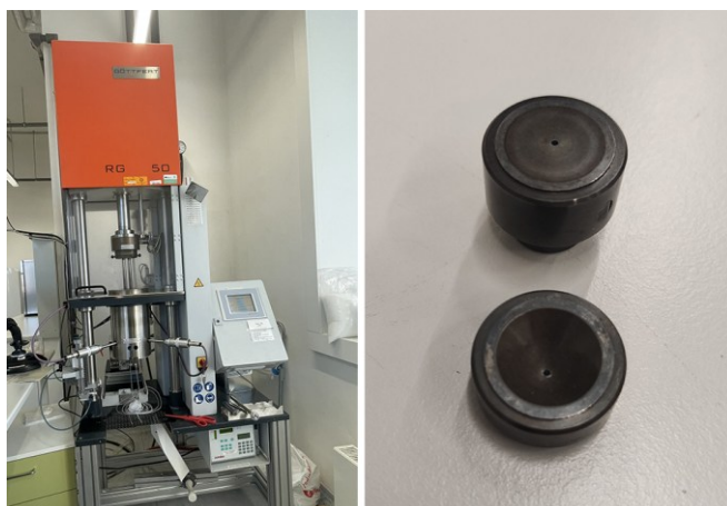
Obrázek 34 Kapilární reometr Göttfert RG50 (vlevo) a kapiláry o průměru 1 mm (vpravo) s délkou 20 mm (nahore) a 0,2 mm (dole)
