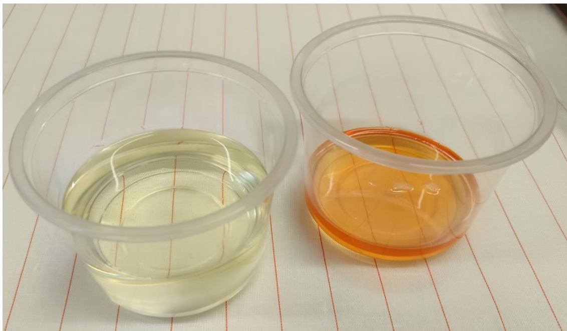
Obrázek 43 Systém Cardolite® – vlevo epoxidová pryskyřice 2501A, vpravo vytvrzovací aminové činidlo 2401B
