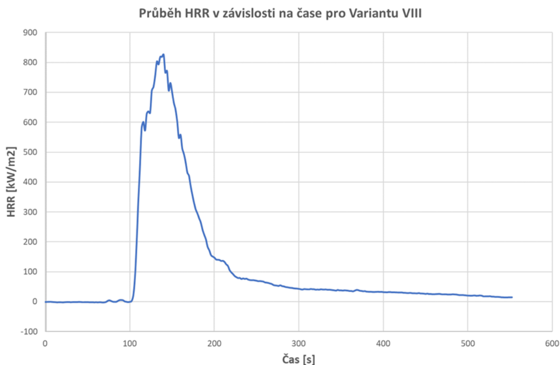
Obrázek 86 Průběh HRR v závislosti na čase pro Variantu VIII
