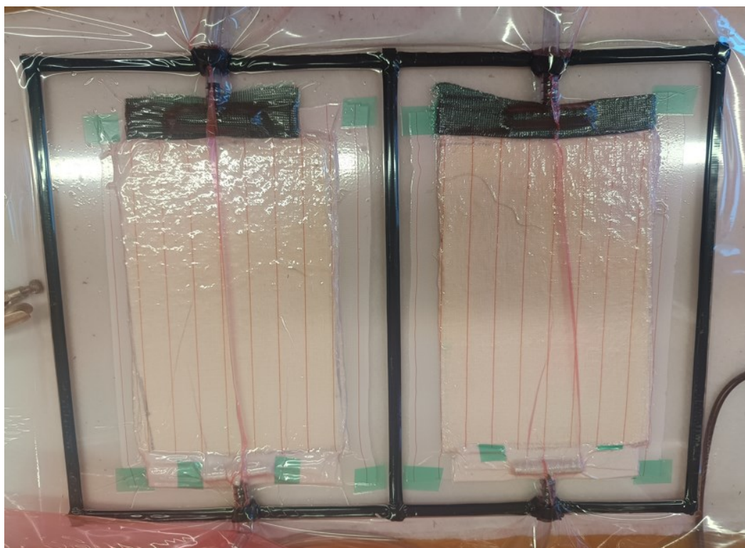
Obrázek 49 Připravena forma pro impregnaci pryskyřicí
