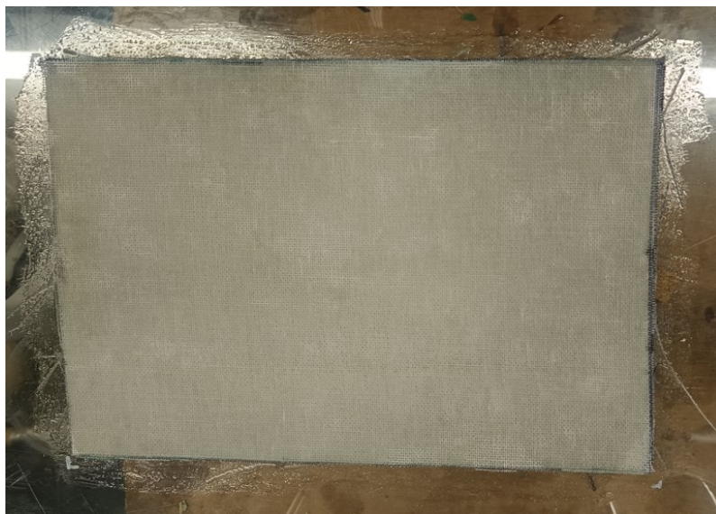
Obrázek 52 Výztuž ručně prosycená matricí 2501A+2401B s příměsí retardantu
