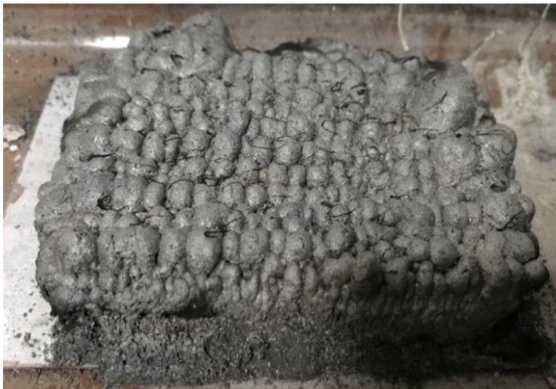
Obrázek 11 Materiál s intumescentním retardantem po požáru
