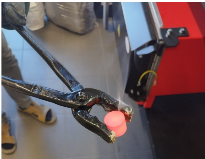
Obr. 19 Ohřátý zkušební vzorek před ochlazením
