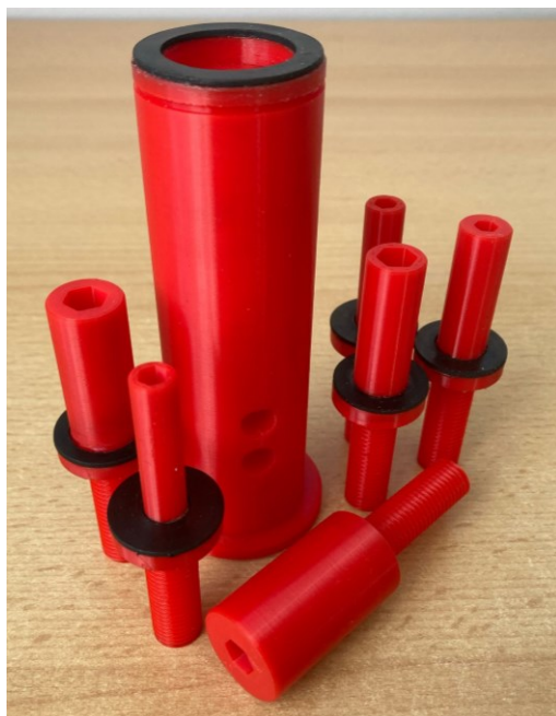
Obrázek 55 Modifikace čepů – výroba 3D tisk [zdroj: vlastní]
