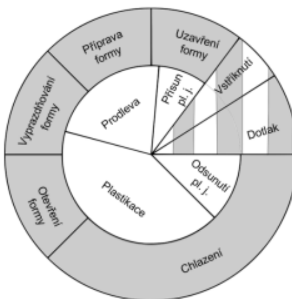
Obrázek 2. Schéma vstřikovacího cyklu činnosti vstřikovací formy (vnější okruh) a vstřikovací jednotky stroje (vnitřní okruh) [8]
