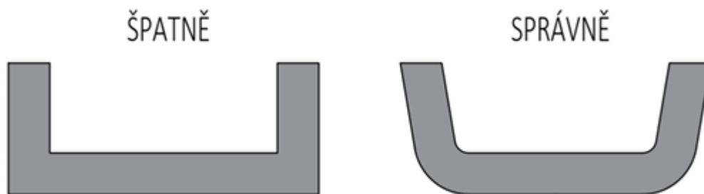
Obrázek 6. Špatně vs správně navržený výrobek s úkosem [15]
