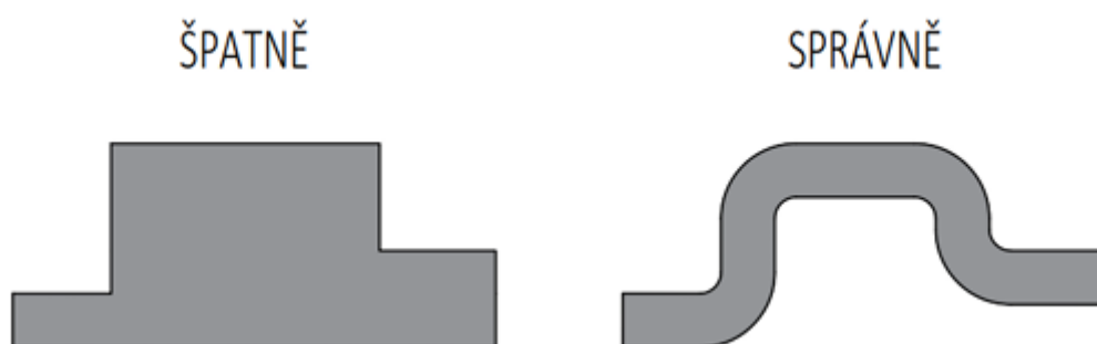
Obrázek 10. Tlustostěnný výrobek v celé tloušťce vs. tenkostěnný s rovnoměrnou tloušťkou stěny [16]
