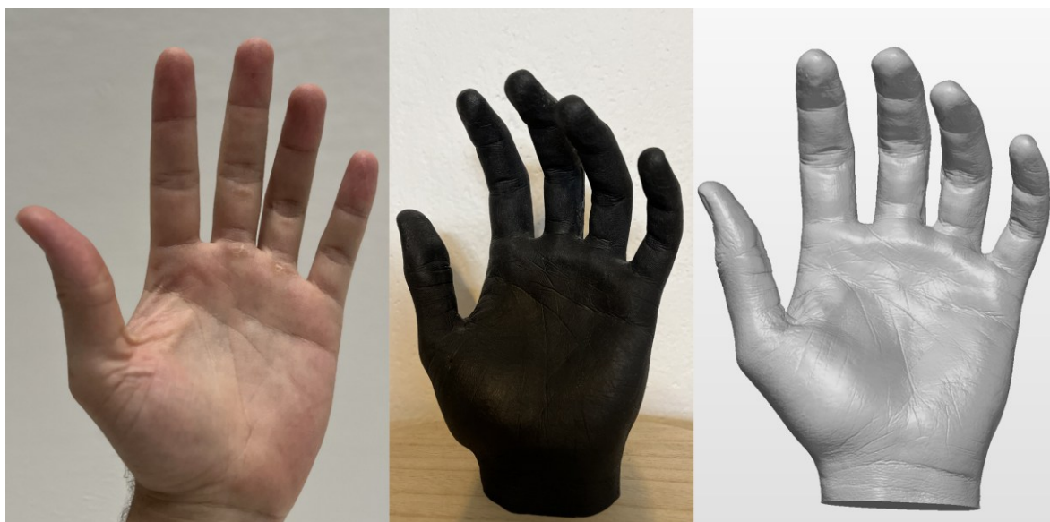
Obrázek 22 Porovnání kvality povrchu originálu, duplikátu a skenu
