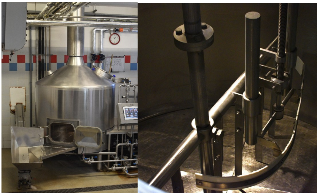
Obrázek 5 Scezovací nádoba minipivovaru X (vlevo: pohled zvenčí, vpravo: kypřidlo)
