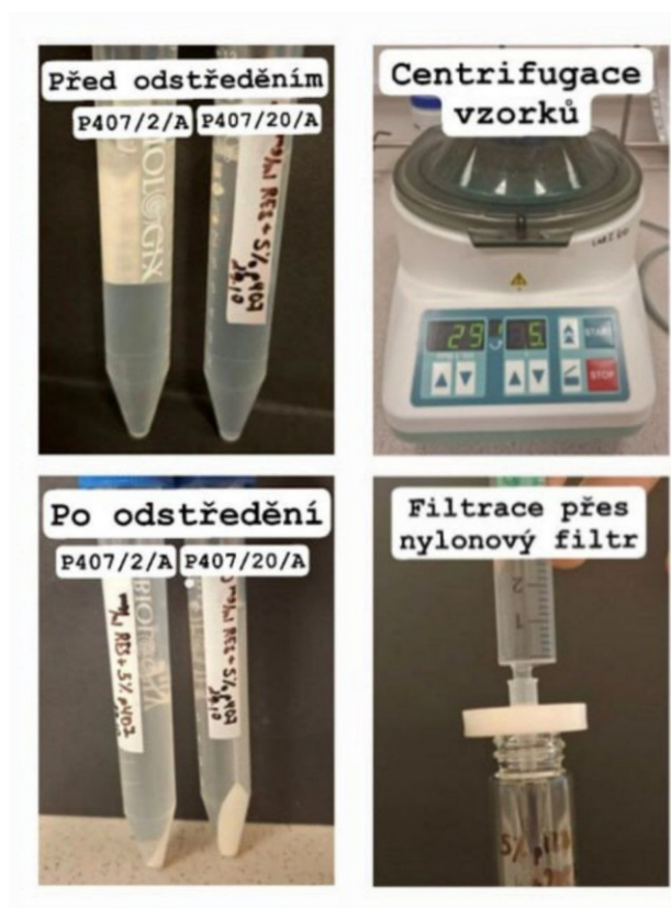
Obrázek 34 Postup přípravy vzorků pro měření enkapsulační účinnosti (zdroj: vlastní)
