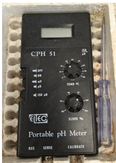
Obrázek 36 Bariérový pH metr CPH 51 s kombinovanou pH elektrodou HC 103
