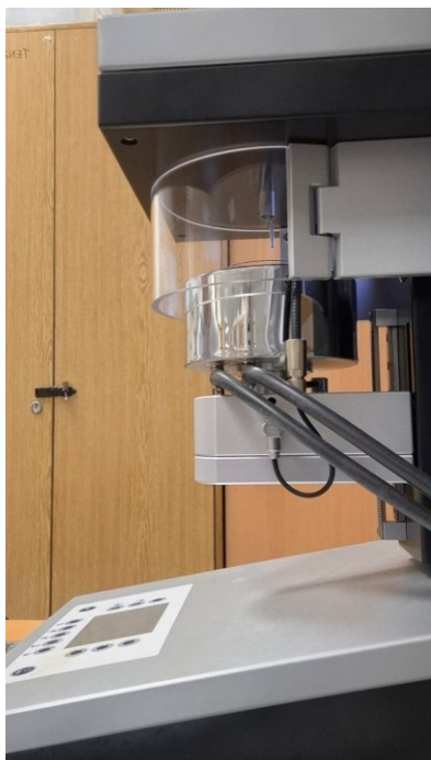
Obrázek 25 Automatický tenziometr KRÜSS K20 EasyDyne
