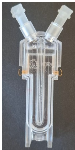
Obrázek 31 Kyveta pro měření zeta potenciálu DTS1070
