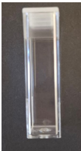
Obrázek 30 Kyveta plastová spektroskopická pro UV oblast, BRAND
