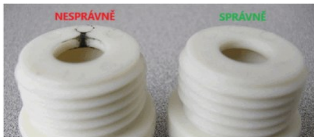
Obrázek 42 Spálené místo po Dieselově efektu
