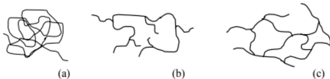
Obrázek 1 Konstituce polymerů a) lineární, b) větvené, c) sesíťované
