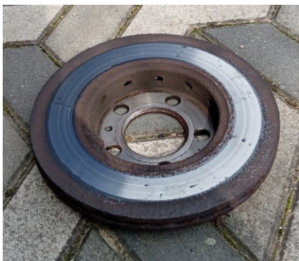
Obrázek 19 Rub demontovaného kotouče
