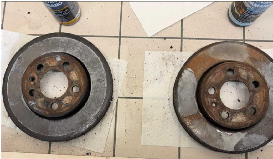
Obrázek 21 Kotouče po působení odrezovačů a stabilizaci po dva dny.
