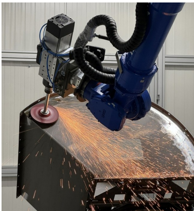
Obrázek 10 Robotické broušení plechu s kompenzátozem přítlaku
