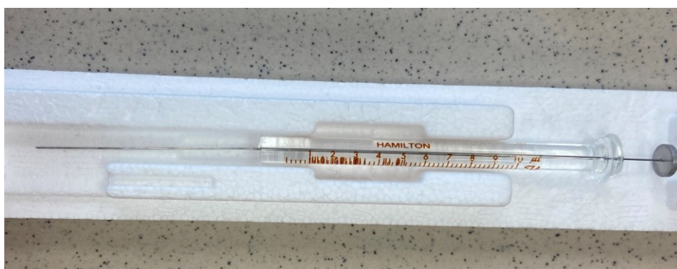
Obrázek 5 Hamiltonova mikrostříkačka použitá pro nástřik vzorků EO (zdroj: vlastní)
