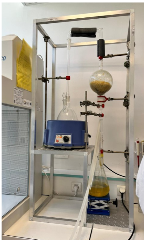
Obrázek 4 Aparatura na destilaci vodní parou z kůry citrusů
