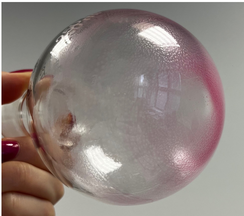
Obrázek 5: Vizualizace tenkého lipidového filmu pomocí barviva na stěnách baňky před samotným hydratováním disperze
