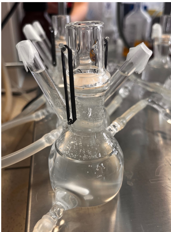
Obrázek 7: Franzova difúzní komůrka s kožním vzorkem
