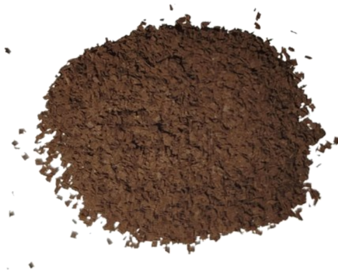
Obrázek 27 Třísky po obrábění nástrojem s diamantovým povlakem
