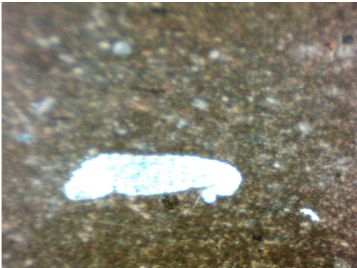
Obrázek 34 Kovové fragmenty v dodaném WPC materiálu - zvětšení 100x
