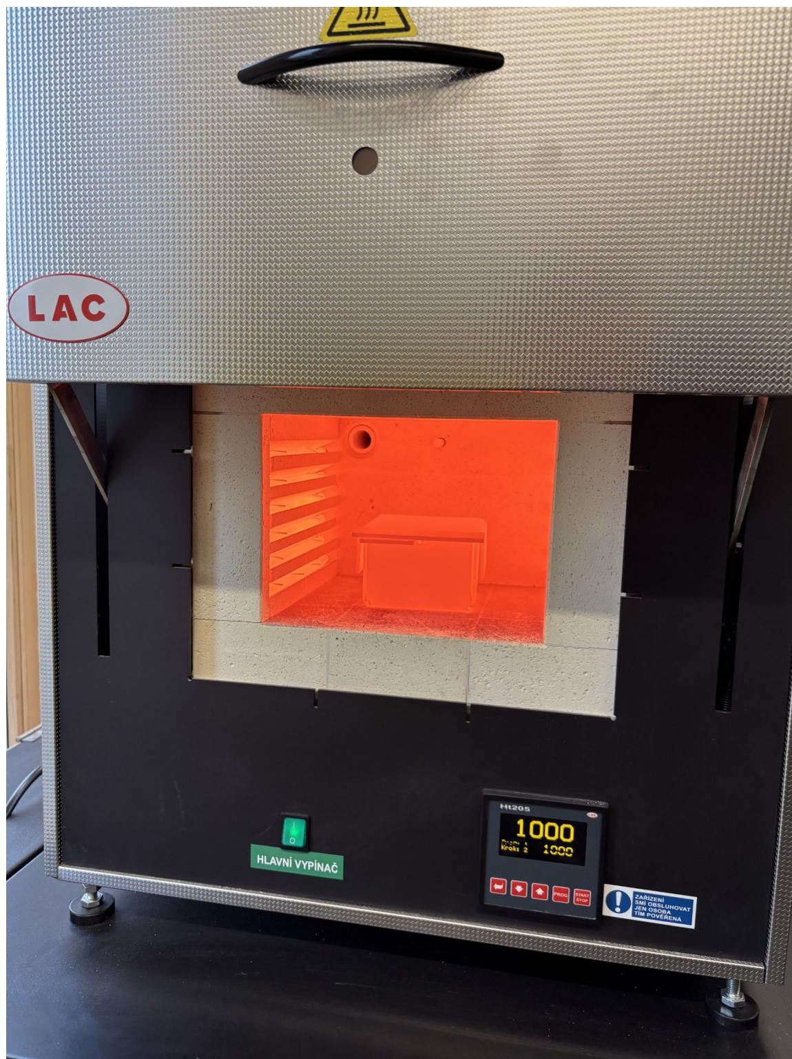
Obrázek 6 Kalící pracoviště s přípravkem na ohřev vzorků
