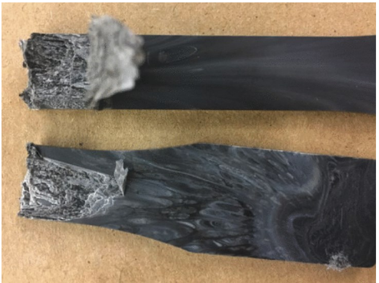
Obrázek 17 Příklad delaminace nekompatibilních materiálů
