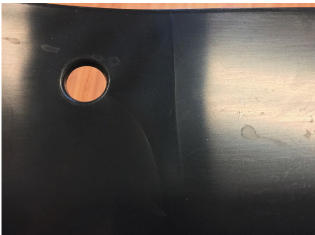
Obrázek 18 Příklad studeného spoje
