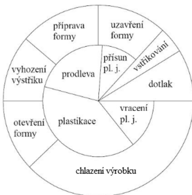
Obrázek 3 Průběh vstřikovacího cyklu
