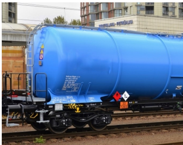
Obrázok 3 Modrý podvozkový cisternový vozeň
