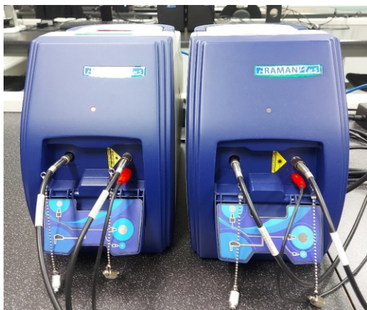
Obrázek 16 Ramanův spektrometr i-Raman Plus
