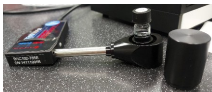
Obrázek 17 Sonda na měření kapalných vzorků
