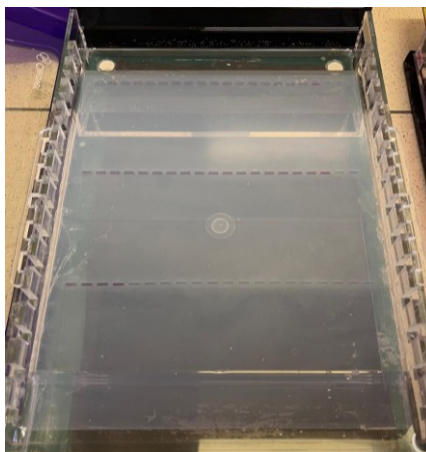
Obrázek 17: Gel s nanесenými PCR vzorky (před elektroforézou)
