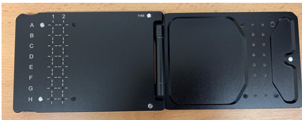
Obrázek 12: Destička k měření koncentrace DNA na přístroji Tecan
