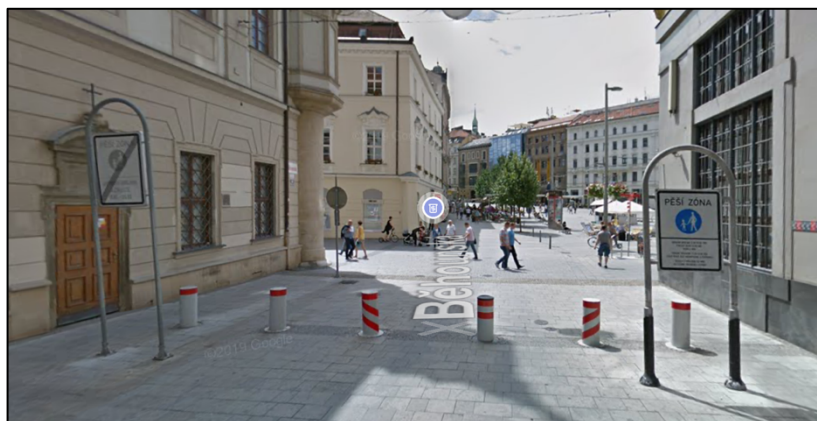
Obrázek 13 Příklad instalace, ochranné sloupy – aktivní, užití SPZ
