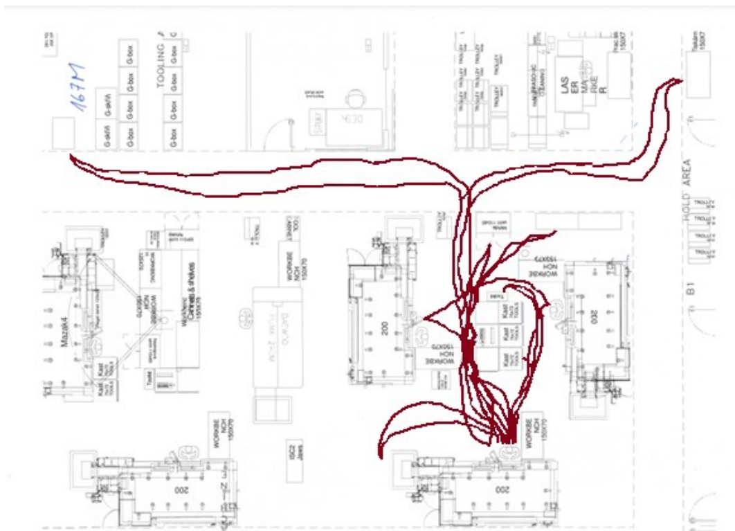
Obrázek 6 Aktuální layout pracoviště, Spaghetti diagram
