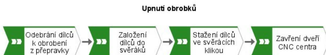
Obrázek 12 Proces upnutí obrobků
