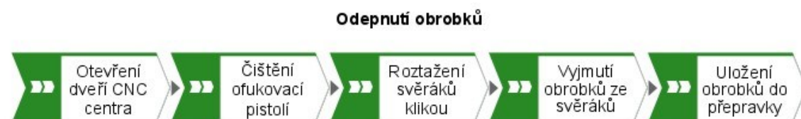
Obrázek 14 Proces odepnutí obrobků
