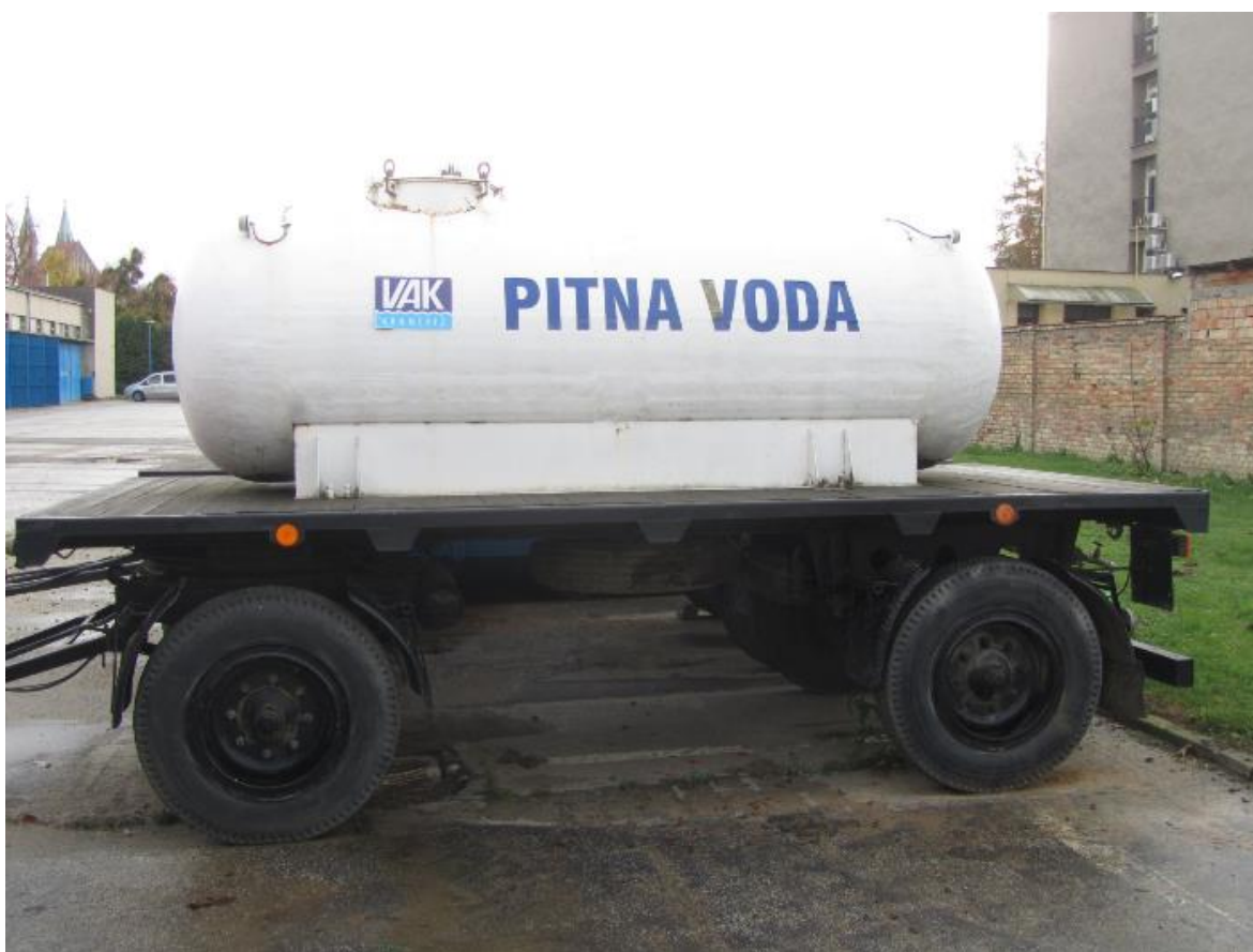
Obrázek 3 - Cisterna s pitnou vodou
