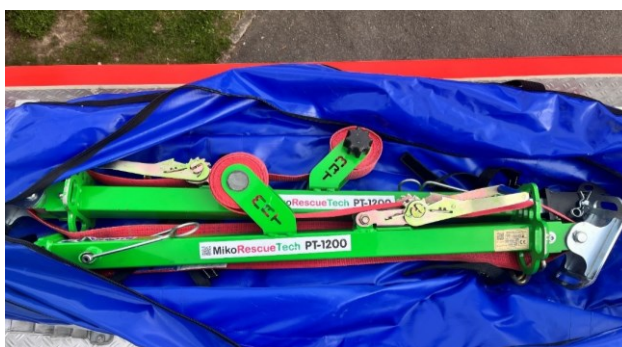
Obrázek 55 Stabilizační tyče (zdroj: vlastní, 2025)
