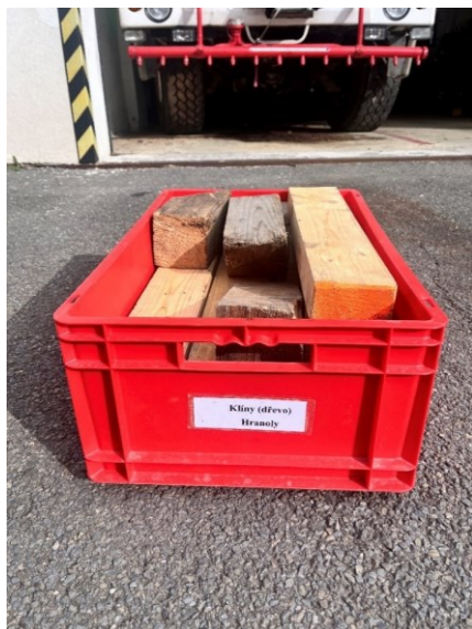
Obrázek 56 Stabilizační klíny dřevěné (zdroj: vlastní, 2025)
