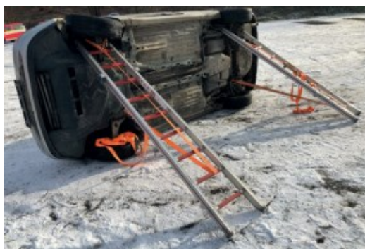
Obrázek 28 Stabilizace vozidla na boku (zdroj: MV-GŘ HZS ČR, 2021)
