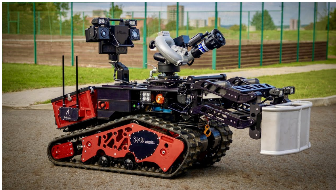
Obrázek 3 Víceúčelový hasičský robot Colossus
