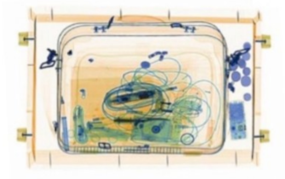
Obrázek 6 - snímek z RTG zařízení, zavazadlo obsahující IED
