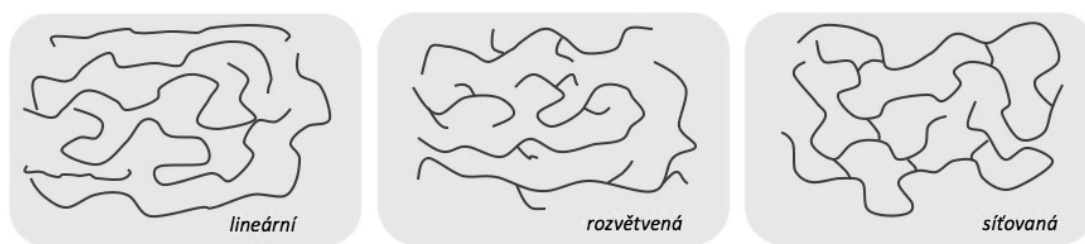
Obrázek 1 Znázornění molekulární struktury polymerů [3]
