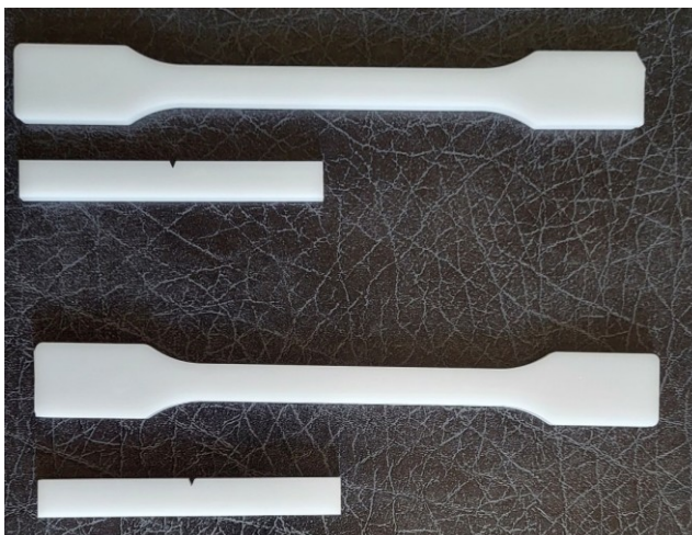
Obrázek 8 Zkušební tělesa pro mechanické zkoušky (nahore bio-based POM, dole POM)
