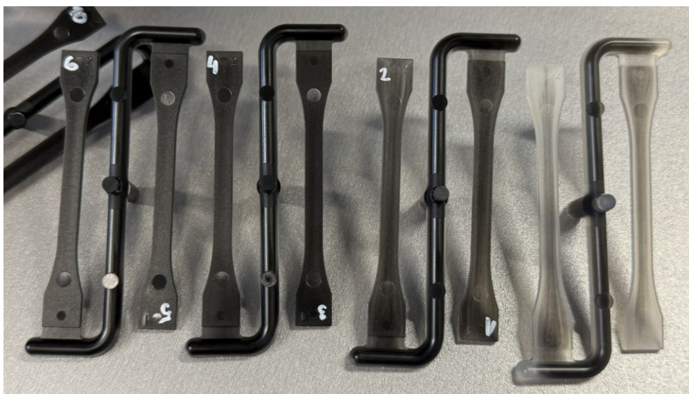
Obrázek 22 - vstřikované oboustranné lopatky pro mechanické zkoušky
