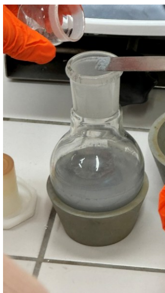
Obrázek 17 - přidávání \text{LiAlH}_4 do reakční baňky
