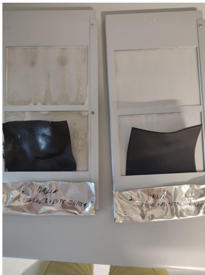
Obrázek 18 Fotka vzorků po urychleném stárnutí, (R35+EG+LDPE 0.5/0.1 Vlevo; Vpravo R35+ EG+ LDPE 0.4/0.05)
