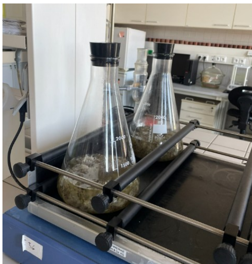
Obrázek 7 Proces odtučňování suroviny na třepačce
