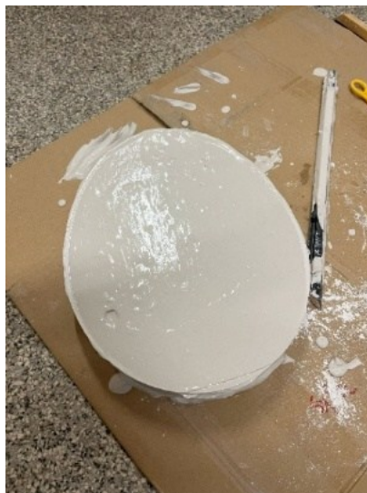
Obrázek 81 Vylévání sádry do formy 104
