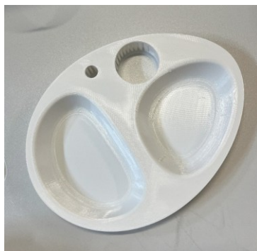
Obrázek 47 První 3D tištěný prototyp více zaoblený 90
