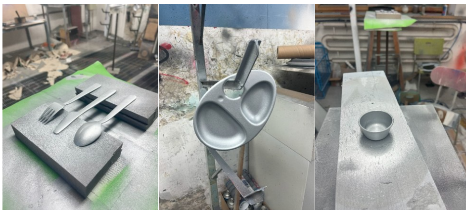
Obrázek 85 Povrchová úprava sprejem
