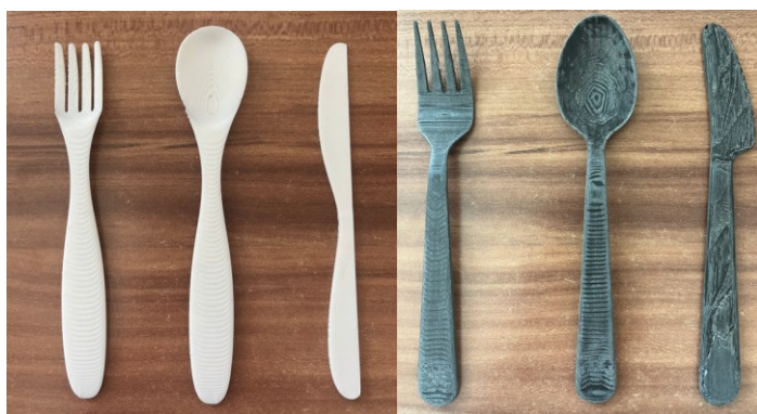
Obrázek 90 První prototyp příboru a druhý finální v průběhu broušení
