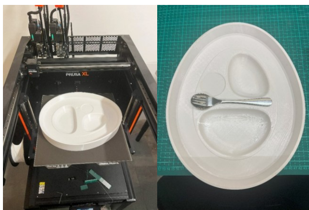
Obrázek 80 Tisk formy a zkouška funkčnosti 99
