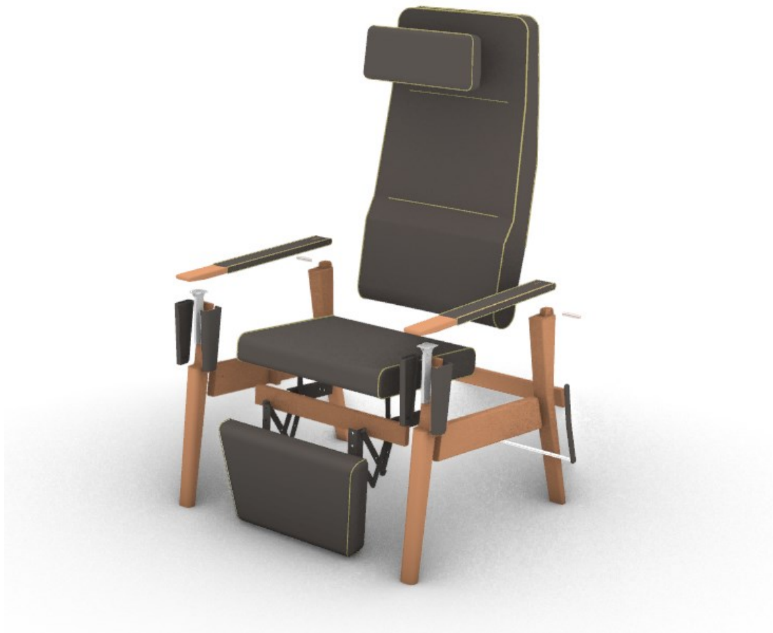
Obr. 88 Základní technické schéma polohovatelného křesla
