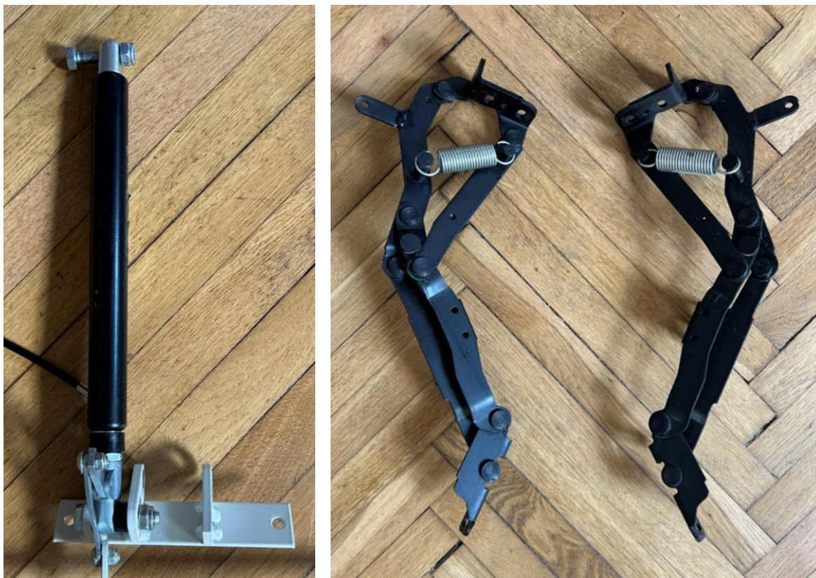
Obr. 91 Plynový píst a polotovary polohovacího mechanismu
