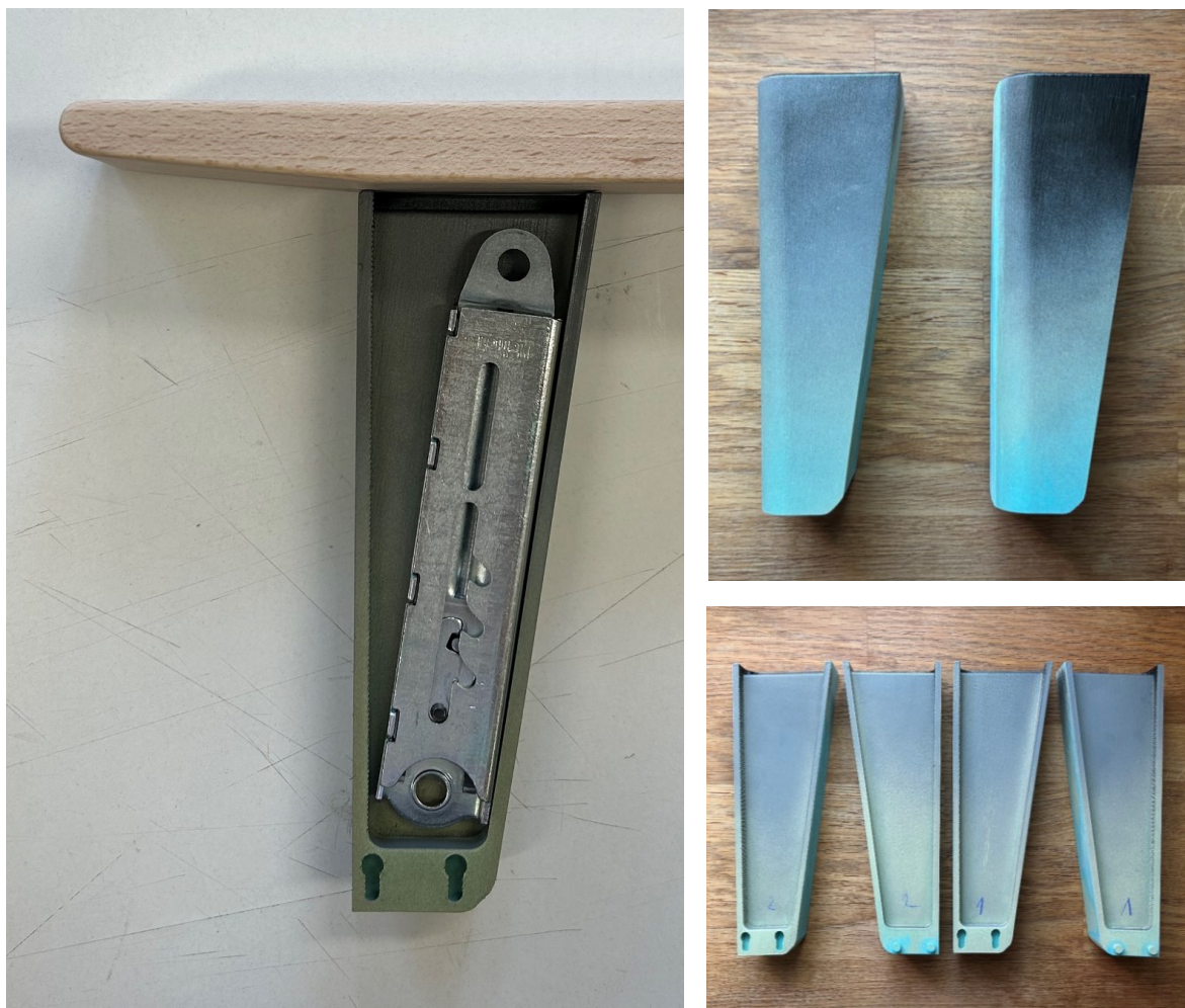
Obr. 93 Umístění rostoucího kování v čelní části přední nohy
