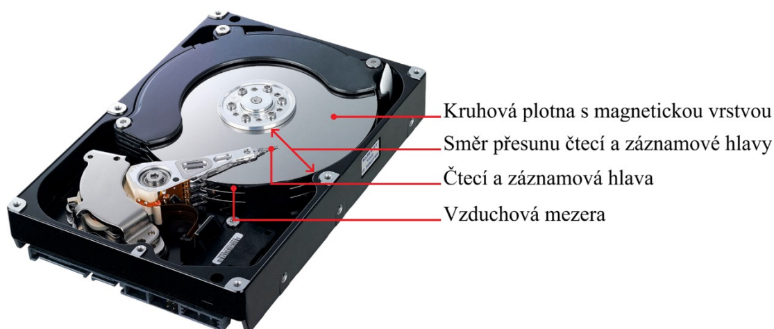
Obr. 10: Vnitřní uspořádání pevného disku [28]
