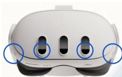
Obr. 17: Meta Quest 3 s označenými kamerami [14]
