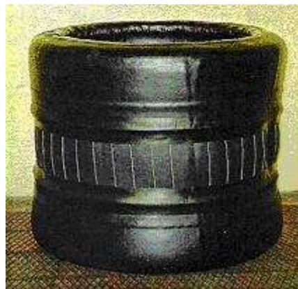
Obr. 13 Kostra nákladního radiálního pláště – 1. stupeň
