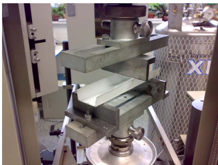
Obr. 19: Zatěžování profilu ze spodní strany
