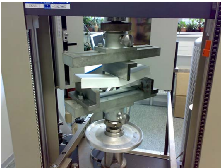
Obr. 18: Zatěžování profilu z vrchní strany
