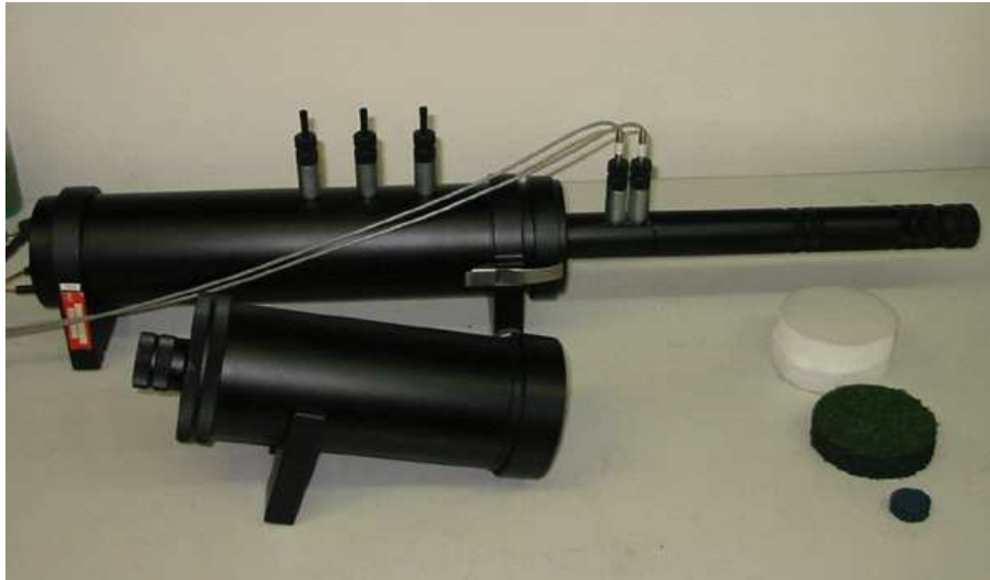
Obr. 11. Kundtova impedanční trubice a vzorky pro měření koeficientu zvukové pohltivosti [18]
