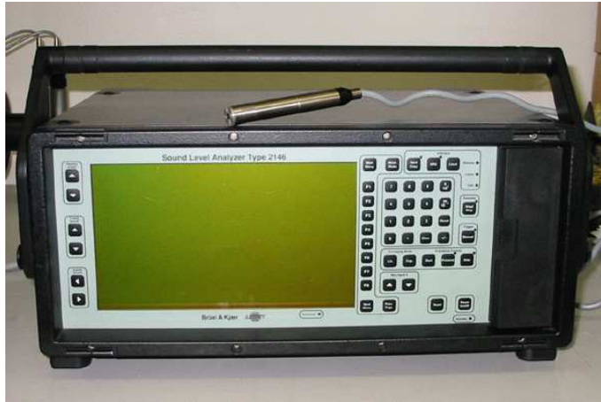
Obr. 13. Analyzátor typu B&K 2146 pro měření akustického útlumu a čtvrtalcový mikrofon typu B&K 4190 [18]
