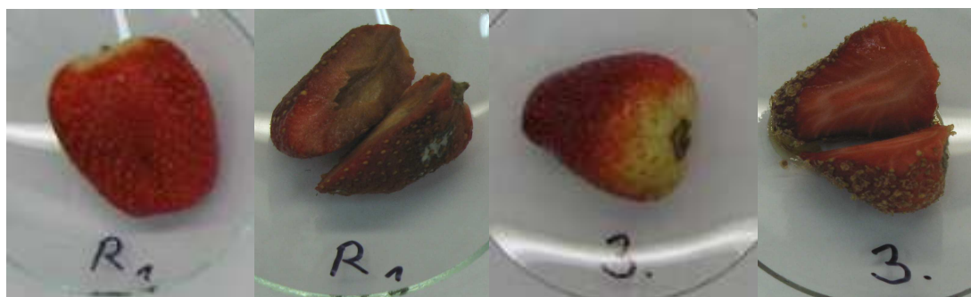
Obr. 64 - Vzorky jahod skladované v lednici na začátku testu a v řezu na konci testu (R 1 – referenční vzorek, 3 – povlak s fixací při 23°C)
