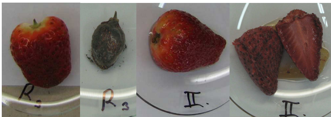
Obr. 39 - Vzorky jahod skladované při pokojové teplotě na začátku testu a v řezu na konci testu (R 3 – referenční vzorek, II – povlak s fixací při 40°C)
