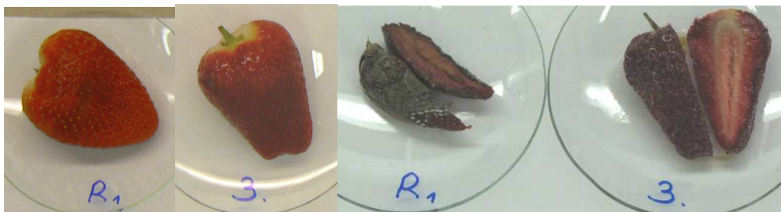
Obr. 15 - Vzorky jahod skladovaných při pokojové teplotě na začátku testu a v řezu na konci testu (R 1 – referenční vzorek, 3 – povlak s fixací při 23°C)
