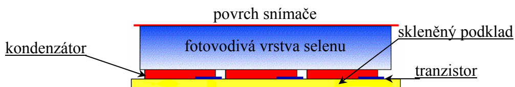
Obr. 18. Řez detektorem s přímou přeměnou
