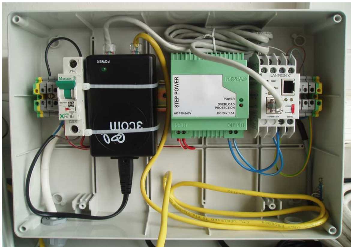
Obr. 50 Otevřený modul mobilního zařízení na převod RS232 ethernet
