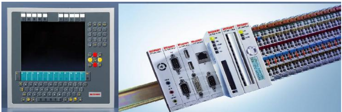
Obr. 16 Kontrolní panel s PC řady CP62xx a Embedded PC
