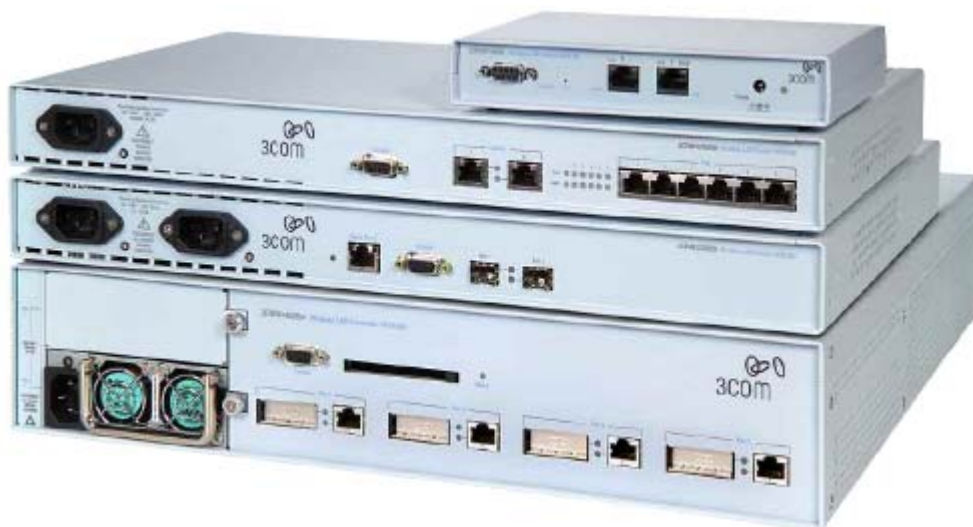
Obr. 28 Wireless Switche řady WX od firmy 3COM v pořadí s hora WRX100, WX1200, WX2200, WX4400
