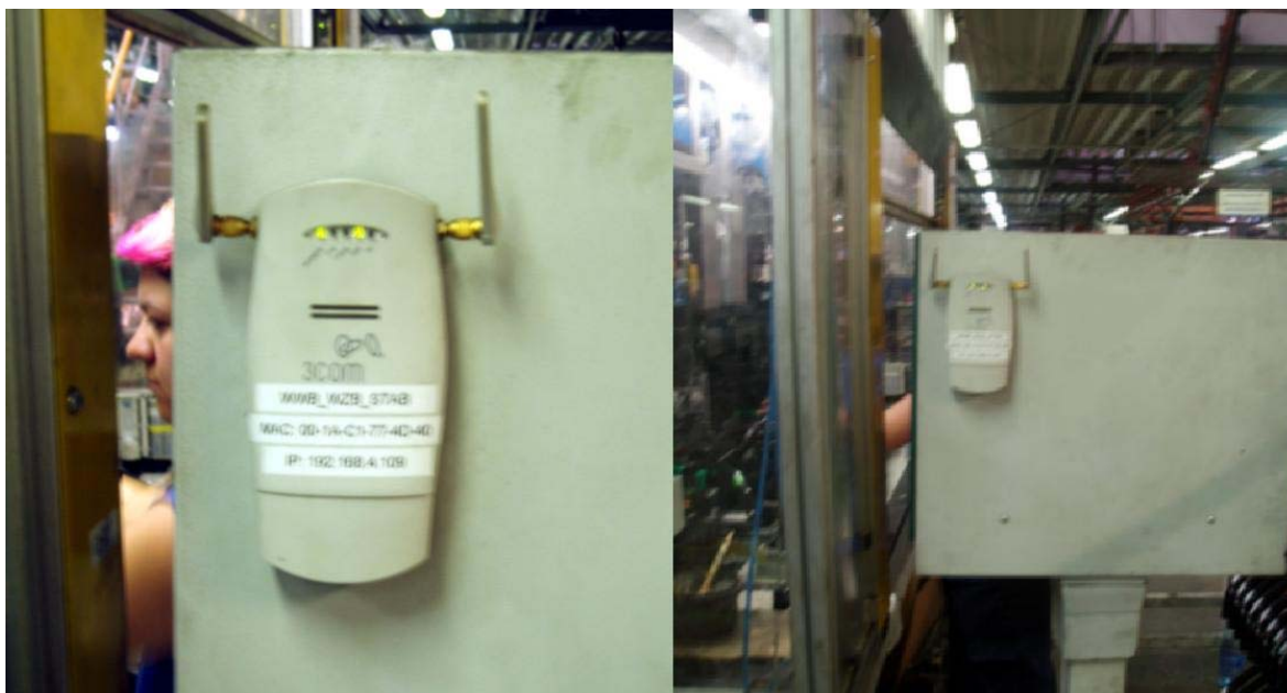
Obr. 48 Montáž AP zařízení na linku FIAT 312
